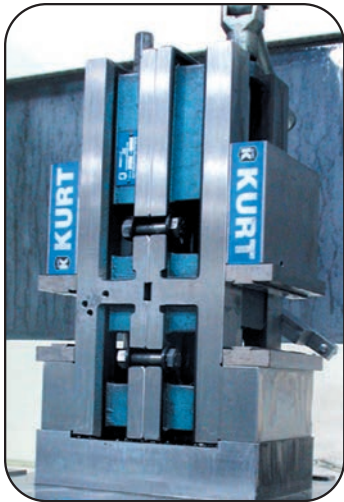
图示为两台3600VM型 背对背安装在 一起,组成一个快速、简捷并很经济的双工位方箱。底座可用于绝大部分卧式加工中心。
