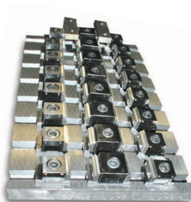
方案: 八工位旋转台夹具进行高速加工。
