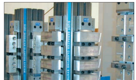
方案：齿型四面体钳组成多台机床托盘系统进行不间断生产。
