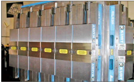
方案：双工位钳组件使用同时装夹18个工件精密加工。
