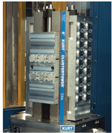
使用了基础板和可加工钳口的四面体钳
