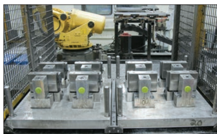
方案: 用于柔性生产单元的磨削夹具系统。
