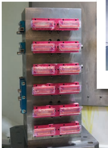
DoveLock 钳口使用在玻璃加工中
