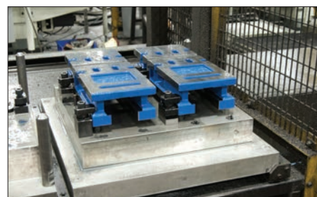
方案: 磨削夹具提高夹紧性能并改善精度。
